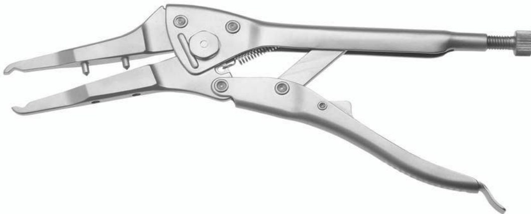
24,5cm / 9 ½" 27-01-30-1606 für Ø4,0mm Stab / for Ø4,0mm rods 27-01-25-1604 für Ø5,5mm Stab / for Ø5,5mm rods 27-01-25-1610 für Ø6,0mm Stab / for Ø6,0mm rods Stabrotationszange mit 2 Führungsstiften um Verdrehung zu vermeiden Rod Rotation Pliers with 2 pins to prevent torsion
